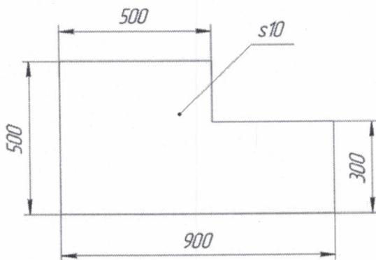
Толщина фанеры, из которой выпилена деталь, равна 10 мм. На чертеже размеры указаны в миллиметрах. Плотность фанеры равна  $615 \text{ г/Дм}^3$ . Определите массу детали. Ответ выразите в граммах, округлив результат до целого числа. Округление стоит производить только при получении финального ответа.
