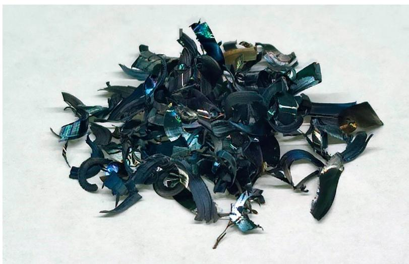
*Рис. 1. Железная стружка*
